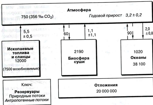
Рис. 5.9. Упрощенный вариант глобального цикла углерода. Цифры в рамках отражают размер резервуара в Гт С. Стрелки представляют потоки, а связанные с ними числа соответствуют размеру потока в Гт · год -1 . По IPCC (1994).
