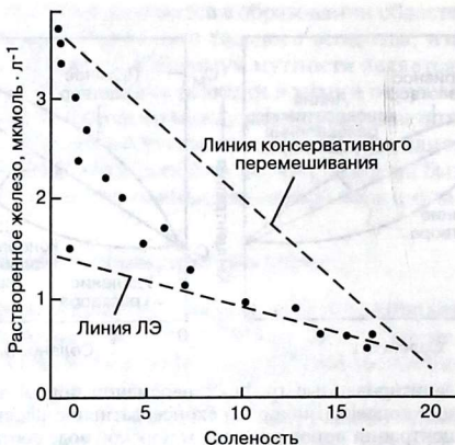
Рис. 4.3. Зависимость концентрации растворенного железа от солености в дельте р. Мерримак (восток США), иллюстрирующая неконсервативное поведение. Линейная экстраполяция (ЛЭ) к нулевой солености данных по железу в области высокой солености позволяет приблизительно рассчитать, что 60 % железа выносятся при низкой солености. Из Geochimica Cosmochimica Acta , 38, Boyle, E. A., Colier, R., Dengler, A. T., Edmond, J. M., Ng, A. C. & Stallard, R. F. On the chemical mass-balance in estuaries, 1719–1728, Copyright 1974, по любезному разрешению Elsevier Science Ltd, The Boulevard, Langford Line, Kidlington OX5 1GB, UK.
