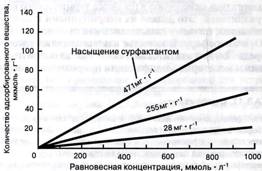
Рис. 3.21. Адсорбция 3-монохлорфенола из воды на смектит Al_{13} , содержащий различные количества сурфактанта Тергикола 15s-5. По Michot & Pinnavaia (1991).
